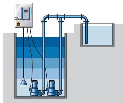
Commande en configuration vidange et régulation de niveau par flotteur.
