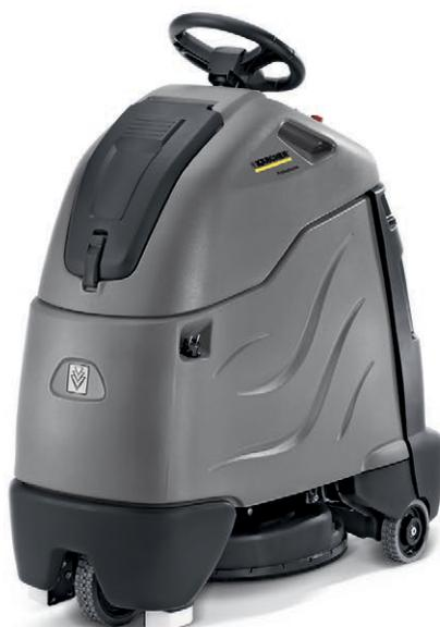
La monobrosse ultra haute vitesse BD 50/2000 RS possède la manœuvrabilité d'une machine autotractée et la vitesse d'une autoportée. Cette monobrosse est appropriée aux collectivités, hôtels...
