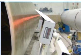
Cette méthode de transformation permet d'obtenir une résistance supérieure à une méthode traditionnelle d'enroulement orthogonal.
