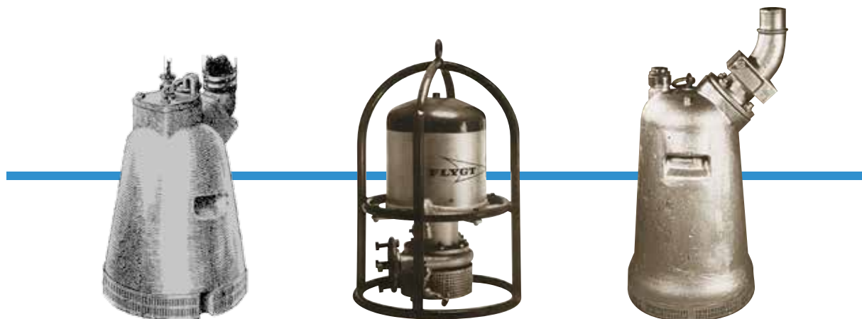
Les pompes submersibles des débuts avaient une forme de cloche distinctive.
