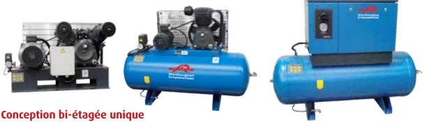
Les modèles bi-étagés sont constitués d'un ou deux cylindres ayant un étage de compression basse pression en partie haute, et un étage de compression haute-pression en partie basse. Cette conception unique permet d'obtenir un excellent rendement dans un encombrement réduit, et d'accéder à une pression de 15 bar.
