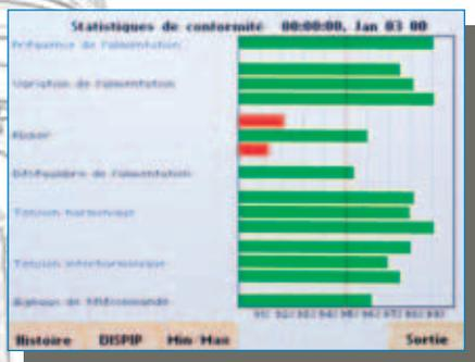
Représenté sous la forme de bargraphe, le résultat de l'analyse temps réel présente l'ensemble des mesures imposées par la norme EN50160, telles que déséquilibre ou présence d'harmoniques. Dès que le résultats sort des tolérances imposées, une simple modification de la couleur de la barre l'indique.
