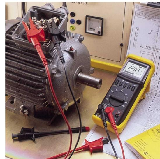
▲ Test de contrôle sur la plaque à bornes d'un moteur électrique triphasé avec le C.A 5220G.
