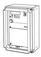
Coffret de commande pour la régulation du niveau d'une pompe submersible. L'acquisition du niveau peut être réalisée avec le procédé pneumatique à injection ou pneumatique de détection via interrupteur à flotteur ou capteur électronique de niveau.
