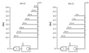
Longueurs max. de la conduite de refoulement DN 32/DN 25, pour garantir un fonctionnement optimal, commencer si possible par poser la conduite de refoulement verticalement puis poursuivre horizontalement (2 coudes 90° et un clapet anti-retour intégré sont requis).
