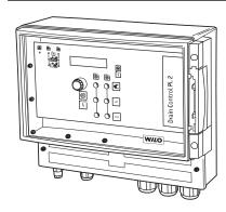
Coffret de commande, pour la régulation du niveau de 2 pompes submersibles. L'acquisition du niveau peut être réalisée avec le procédé pneumatique à injection ou pneumatique de détection via interrupteur à flotteur ou capteur électronique de niveau.
