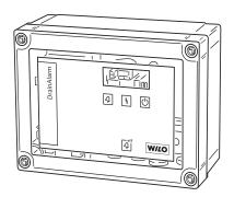
Coffret d'alarme pour montage mural avec message d'alerte optique et sonore (vibreur) 85 dBA, bloc d'alimentation à rechargement automatique, contact sec, coffret ISO, classe de protection IP 54, 1~230 V. Prévoir un interrupteur à flotteur WA... en tant que capteur.
