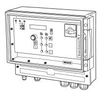
Coffret de commande, pour la régulation du niveau de 2 pompes submersibles. L'acquisition du niveau peut être réalisée avec le procédé pneumatique à injection ou pneumatique de détection via interrupteur à flotteur ou capteur électronique de niveau.
