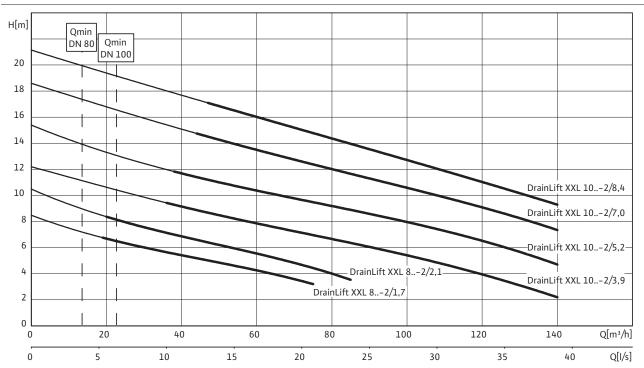
Conformément à EN 12056-4,6.1, respecter une vitesse d'écoulement (dans la conduite de refoulement) entre 0,7 et 2,3 m/s. Les valeurs  $Q_{min}$  indiquées se rapportent au diamètre intérieur des tuyaux en acier à paroi normale.
