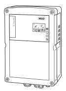
Coffret de commande pour la régulation par niveau de 1 pompe submersible pour eaux usées ou pour eaux chargées des gammes Wilo-Drain ou Wilo-EMU. Le niveau peut être détecté via un système pneumatique de détection ou 2 interrupteurs à flotteur.
