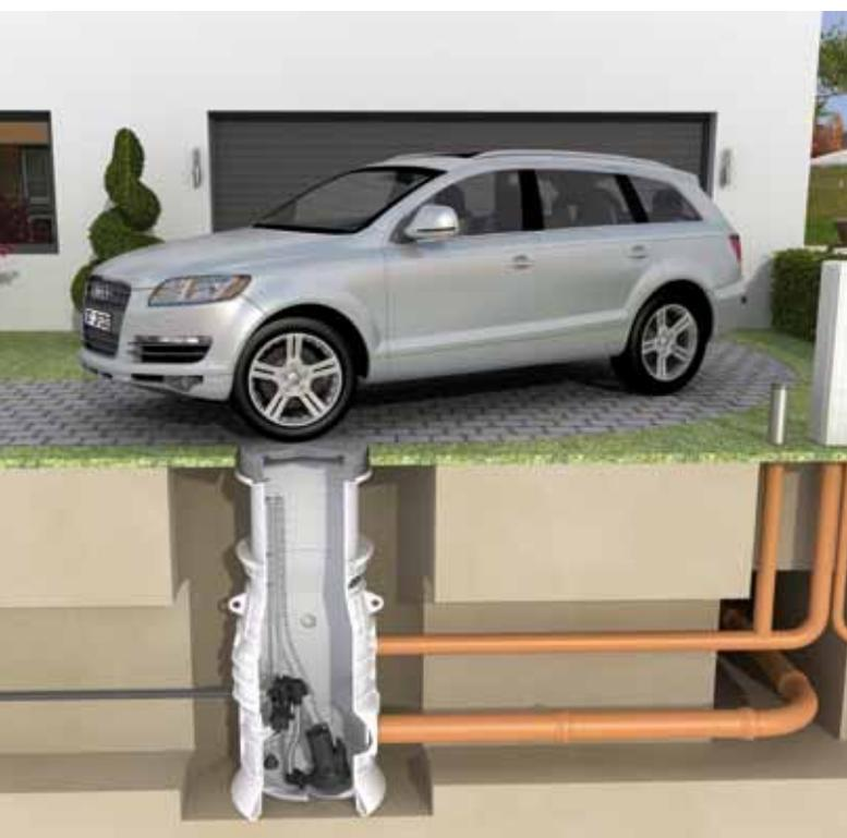
Selon le lieu de montage, la cuve doit pouvoir supporter des charges plus ou moins importantes. Dans ce cas, une PKS-B 800, qui peut supporter une charge jusqu'à 12,5 t, est installée.
