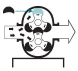
Les pompes à lobes Börger équipées de leur technologie brevetée sont reconnues pour leur facilité de maintenance. Le blindage du corps de pompe par ½ coquille ainsi que l'exécution M.I.P assure un démontage de l'ensemble des pièces en contact avec le fluide pompé sans démontage de la tuyauterie ni désaccouplement. 15 tailles disponibles de 1 à 1050 m³/h soit 17 à 17 500 l/mn
