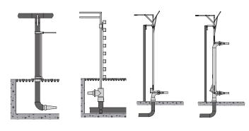
La décantation / sédimentation des boues ou du lisier à l'intérieur des silos impose une agitation efficace. Les tuyères immergées Börger sont reconnues pour leur efficacité et leur robustesse. Disponible en inox en exécution simple ou double tuyère pour les silos de grande capacité.
