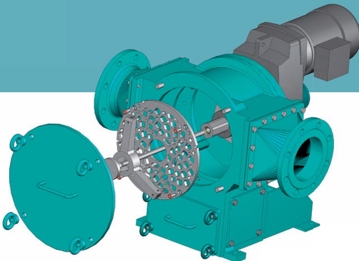
Le Multichopper Börger est un robuste dilacérateur en ligne destiné aux utilisateurs soucieux de raffinement technologique. Une exécution en ligne, un réglage des couteaux s'effectuant sans démontage par l'extérieur et une maintenance aisée sont les principaux avantages de cette génération de broyeurs dilacérateurs. L'étanchéité est assurée par une robuste garniture mécanique évoluant dans un bain d'huile. Elle ne nécessite aucun entretien ni surveillance.
