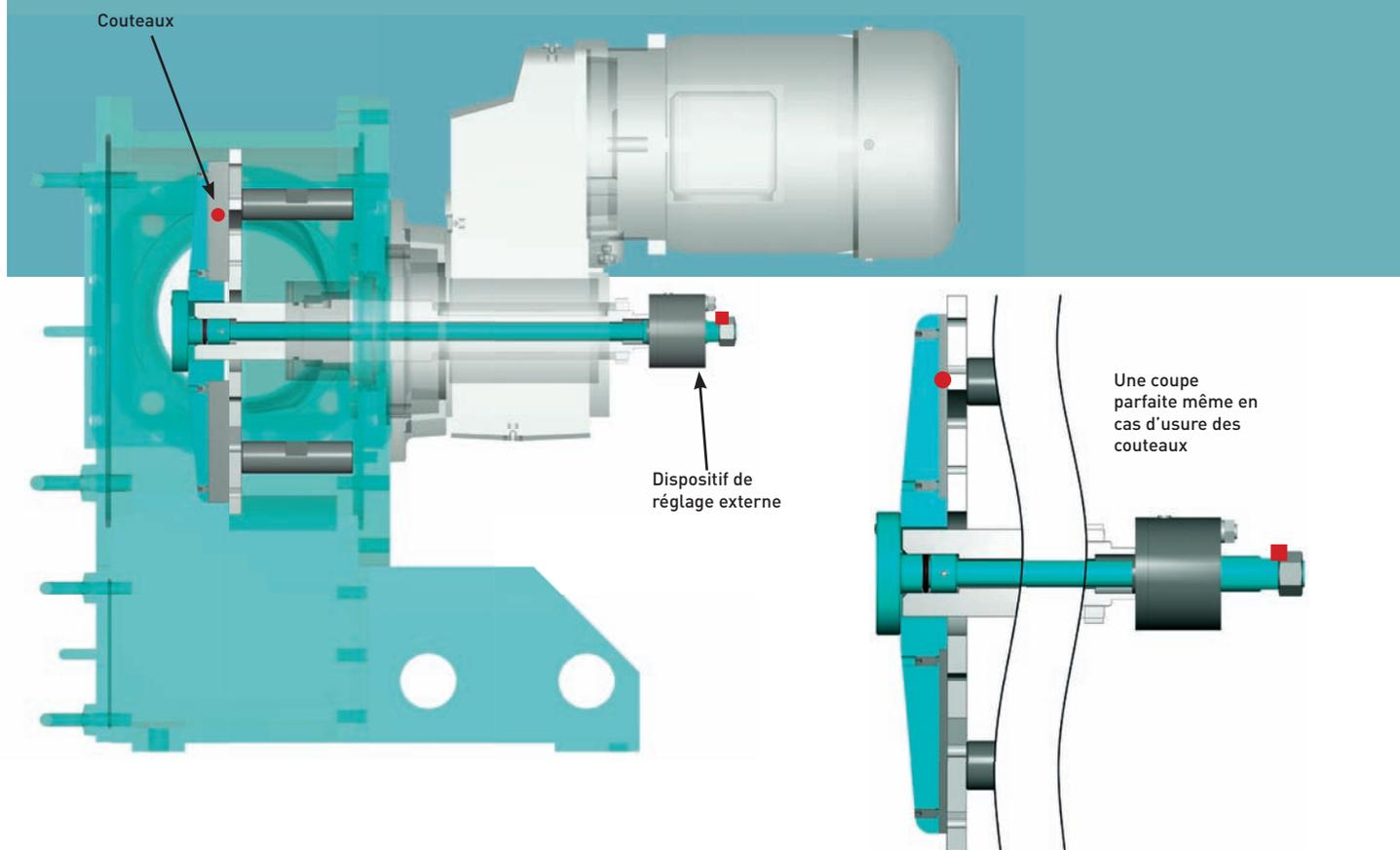
Le nouveau réglage automatique de l'effet de coupe MCA est un système totalement autonome. Le cylindre est lié directement à l'arbre principal du porte-couteaux. Il assure un effet de traction du porte-couteaux et des couteaux sur la grille de coupe. A chaque rotation moteur, l'ajustement est automatiquement réalisé par le MCA. Cette force de traction opère de façon à ce que le jeu entre les couteaux et la grille de réduction soit nul. Ainsi, l'effet de coupe est le même jour
